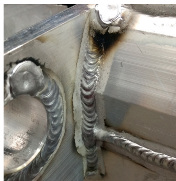
El argón da como resultado una gran zona de limpieza y con una penetración de soldadura moderada.
