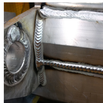
STARGOLD® Aluminium proporciona una superficie más lisa con una zona de limpieza mucho más pequeña y una mejor penetración de soldadura.
